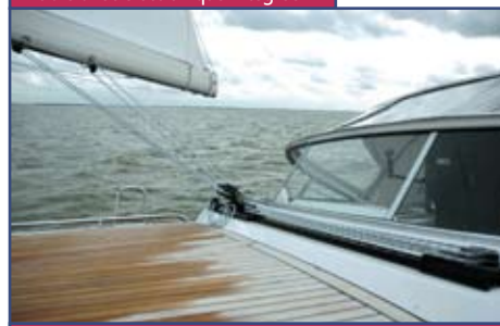
Rail de GV en avant du roof avec bare-brise en dur à la façon Hallberg-Rassy
